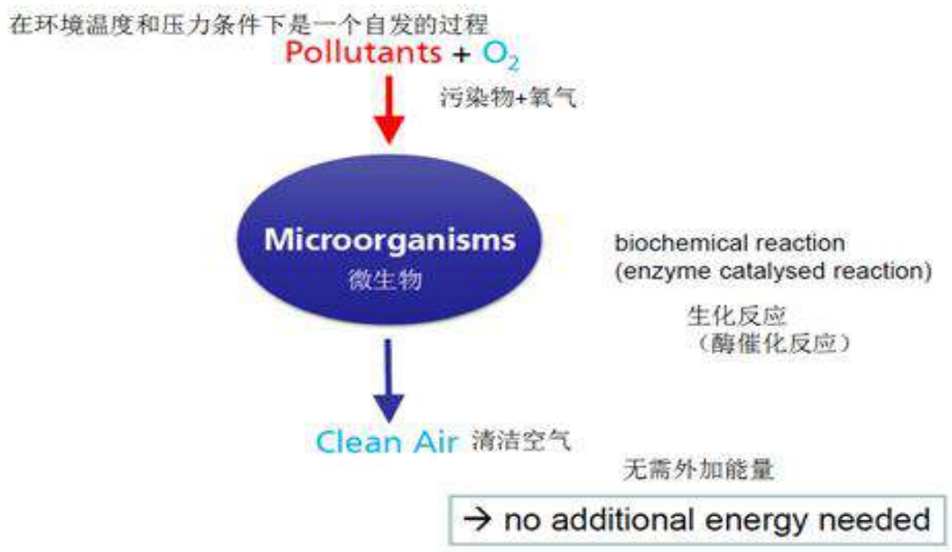
图 9.2.1-2 废气净化基本原理图
