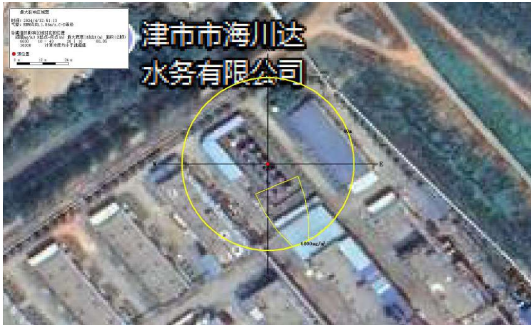
图 10.3.2-27 乙酸乙酯达到不同毒性终点浓度的最大影响范围示意图（最常见气象）
