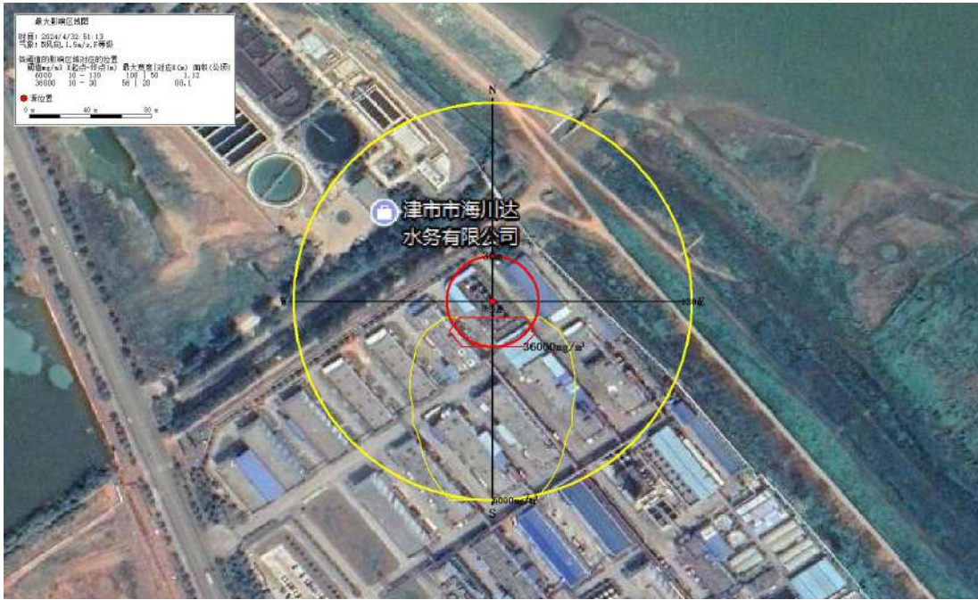
图 10.3.2-25 乙酸乙酯达到不同毒性终点浓度的最大影响范围示意图（最不利气象）
