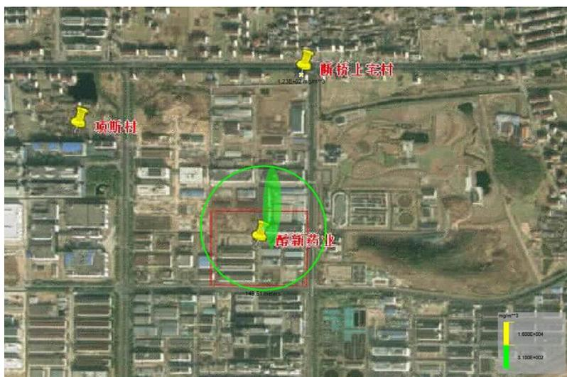
图 6.3.5-3 氯仿储罐泄漏影响预测图
